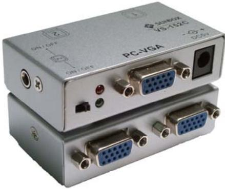
全世界最微小型 2 埠 VGA 畫面分配器，不須使用外接電源供應器，攜帶方便(由 USB 埠取電工作)。
