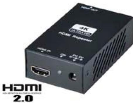
HDMI2.0 線材延長中繼器，支援 HDMI 2.0 規範，輸入端和輸出端各可連接最長 20 米 HDMI 2.0 線材，可串接多層使用。
